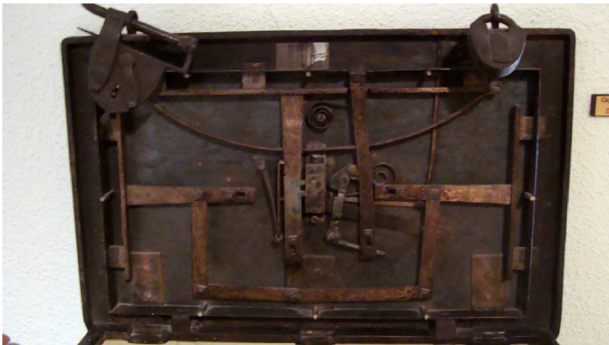
Ilustración 3. Catedral de León. Sistema de cerramiento con resortes bajo la tapa y candados. Fotografía Carmen Rodríguez López.
