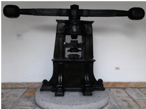
Fig. 7. ¿Proyectada por Tomás Sánchez Reciente? C. 1759-1767. Prensa de acuñación. Bronce fundido. Banco de la República. Casa de Moneda (Bogotá). Foto: autor.
