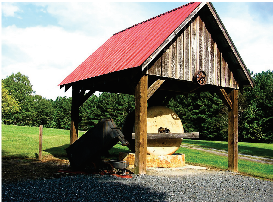
Imagen 3. Molino chileno de minerales original del siglo XIX y carretilla de mineral exhibidos en el Parque Histórico de las minas de Gold Hill, North Carolina, Estados Unidos. Foto de Vivian Hopkins, Vice President, Historic Gold Hill and Mines Foundation, Inc., Gold Hill, North Carolina USA, 2017. Cortesía de la autoría y de la Historic Gold Hill and Mines Foundation, Inc.
