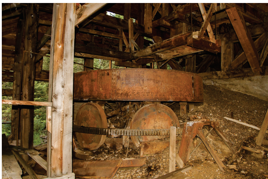
Imagen 4. Molino chileno del tipo “lane slow-speed” abandonado en el edificio de un molino de minerales en Winneka, Montana, Estados Unidos, construido probablemente en 1930 por la Winneka Mining Company. El impresionante molino chileno de más de 3 metros de diámetro es todo lo que ha sobrevivido en el lugar. Foto de Guy Starbuck. Cortesía del autor. https://starbuck.org/exploring/ .
