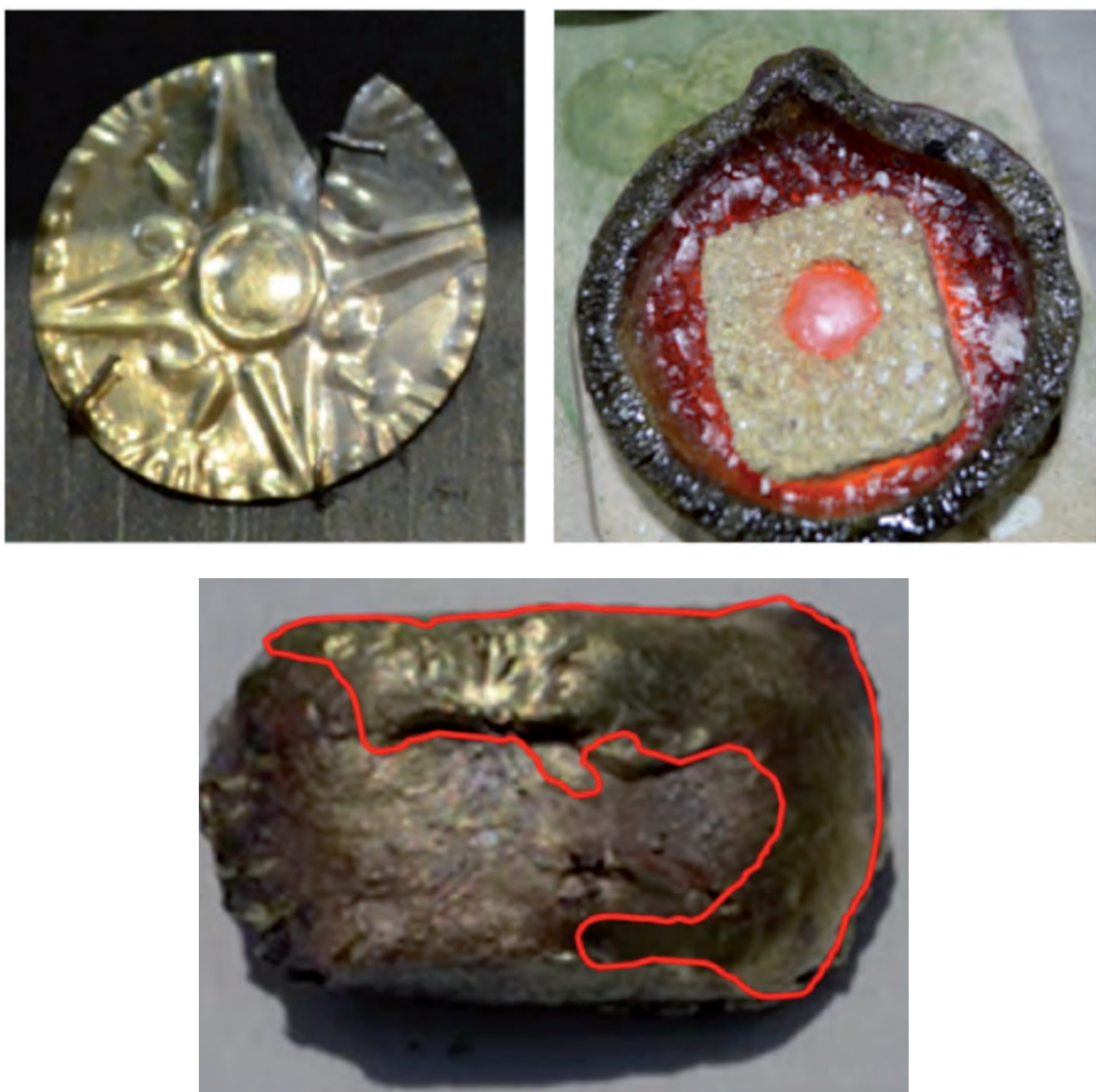
Fig. 12. Arriba a la izquierda, uno de los dos discos bimetálicos de Montealban (Oaxaca, Mexico) (foto cortesía de la Rest. Gabriela Peñuelas). Arriba a la derecha, recreación del proceso de manufactura de una pepita bimetálica (Imagen propia). Abajo, pepita bimetálica de oro y plata. (Imagen propia).
