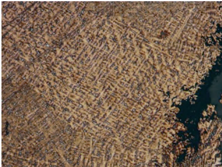
Fig. 20. Clavo M4. Atacado con cloruro férrico X50. Estructura dendrítica similar a la del clavo M2. Se puede apreciar que las dendritas son delgadas, largas y muy ramificadas, lo que indica que el proceso de enfriamiento y solidificación en el molde fue rápido. (Imagen propia)
