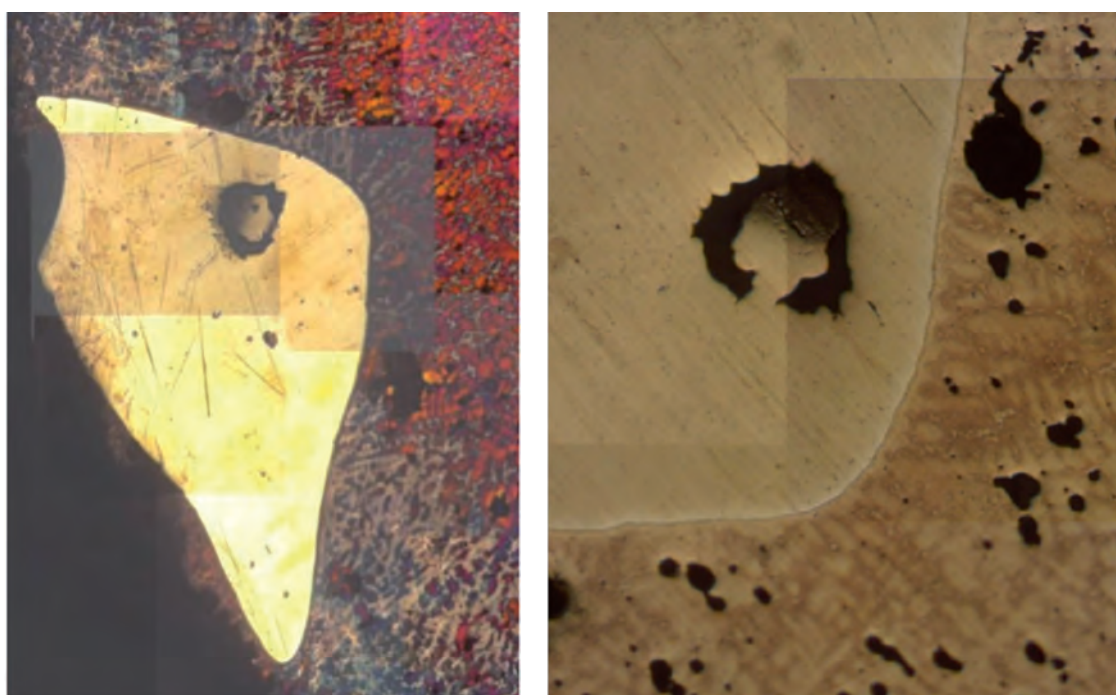
Fig. 13. A la izquierda metalografía X50, de la pepita bimetálica, en campo oscuro. Se observa la sección de oro y el bifásico de plata y cobre, con una estructura dendrítica, característica de una fundición. Abajo detalle de la interfase oro -plata X100, en campo claro. (Imagen propia).
