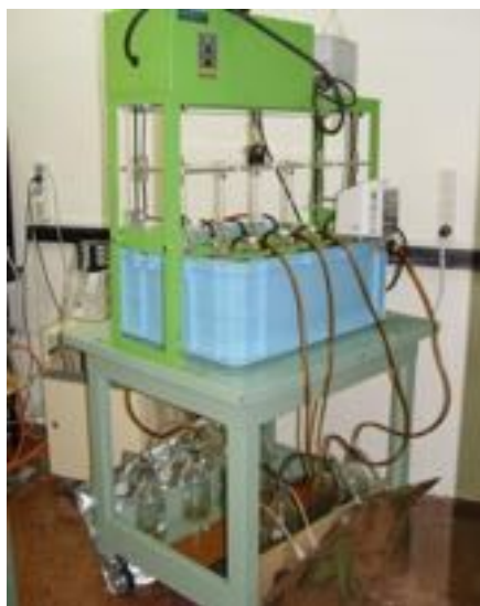
Figura 2. Sistema de 8 fermentadores de flujo semicontinuo (RUSITEC; Rumen Simulation Technique; Czerkawski y Breckenridge, 1977)
