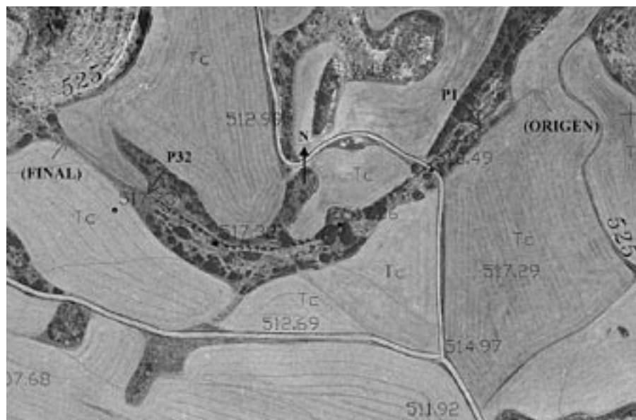
FIG. 8. Prolongación del trazado hasta los probables puntos de origen y final del acueducto.
