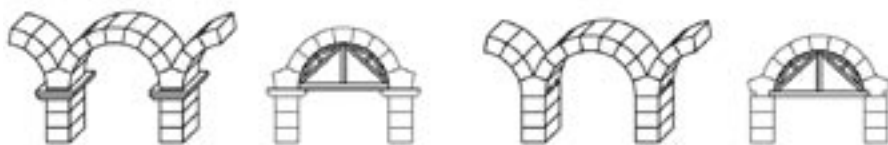
FIG. 10. Sistema de construcción de arcos con cimbra.
