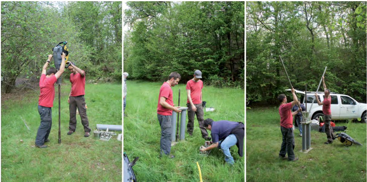
Figura 3. Toma de una muestra en el sector Castelliere de la Bessa mediante una sonda motorizada. Foto: Javier S-Palencia, EST-AP, IH del CSIC.
